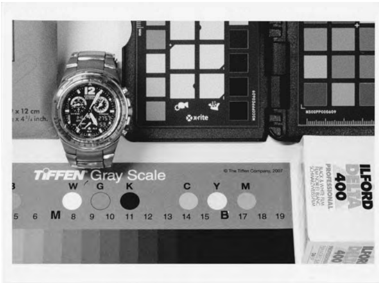
16 kodak: un ingrandimento del test della Ilford Delta 400 Professional: sviluppo in ID-11 in stock, 9 minuti
