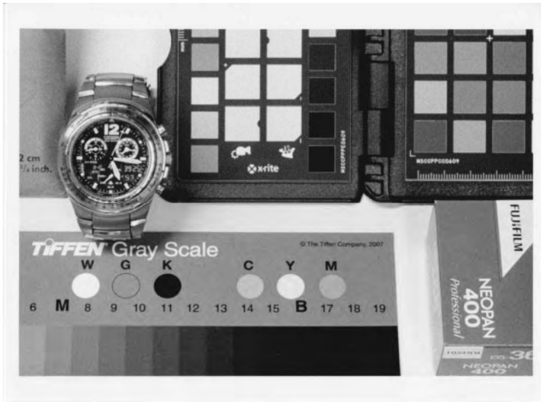
18 kodak: un ingrandimento del test della Fuji Neopan 400 Professional: sviluppo in ID-11 in stock, 7 minuti
