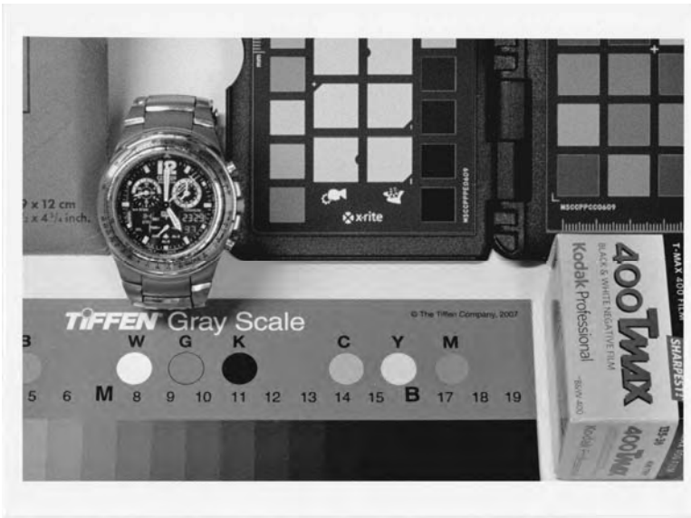
12 kodak: un ingrandimento del test della Kodak TMAX-400: sviluppo in ID-11 in stock, 7 minuti
