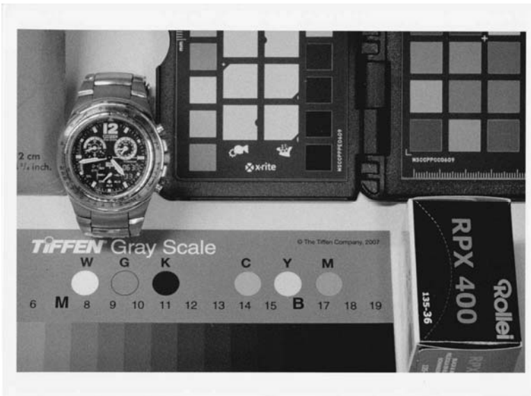
13 kodak: un ingrandimento del test della Rollei RPX 400: sviluppo in ID-11 in stock, 8 minuti
