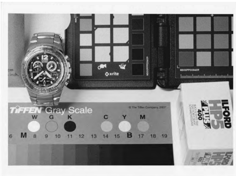
15 kodak: un ingrandimento del test della Ilford HP5 Plus 400: sviluppo in ID-11 in stock, 7 minuti
