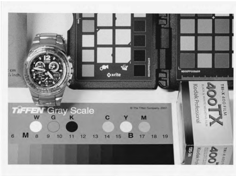
14 kodak: un ingrandimento del test della Kodak TRI-X 400: sviluppo in ID-11 in stock, 7 minuti
